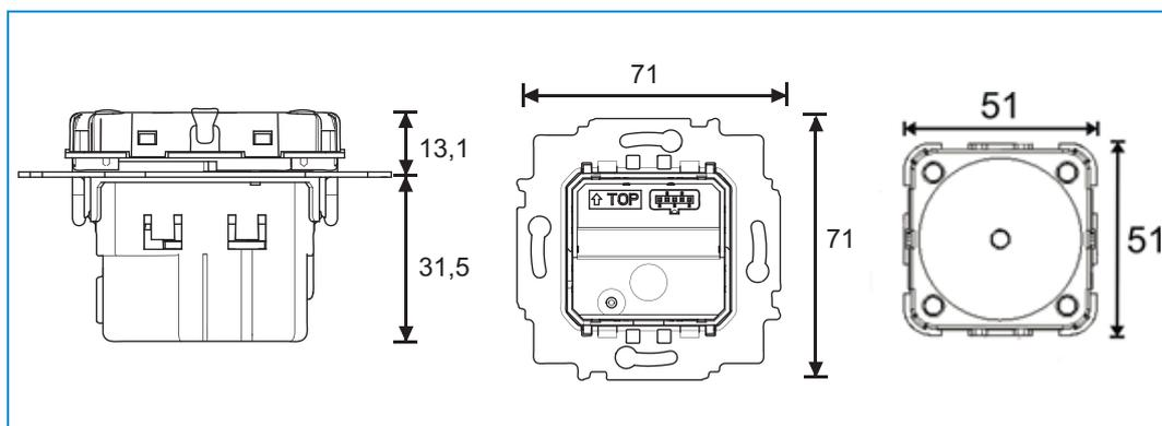
Fig. 4 : dimensions de tous les types d'appareils décrits
