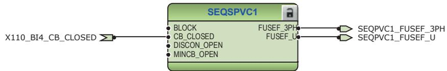
Abb. 531: Funktion für die Automatenfallüberwachung
