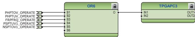
Abb. 560: Zeitglieder-Logik für Spannungs- und Frequenzschutz-Auslöseimpuls
