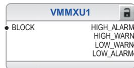
Abb. 489: Spannungsmessung: Dreiphasige Spannungsanzeige
