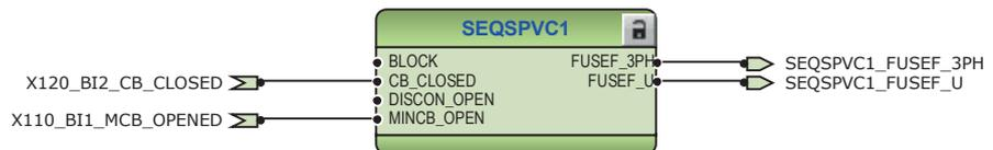
Abb. 190: Funktion für die Automatenfallüberwachung
