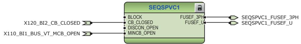
Abb. 352: Funktion für die Automatenfallüberwachung
