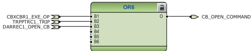
Abb. 363: Signale für Ausspule des Leistungsschalters 1
