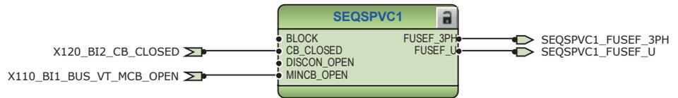
Abb. 412: Funktion für die Automatenfallüberwachung
