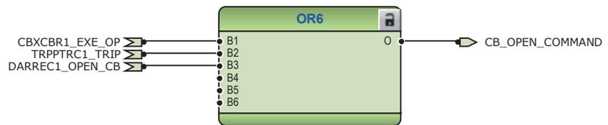
Abb. 116: Steuerungslogik des Leistungsschalters: Signal für das Öffnen des Leistungsschalters 1
