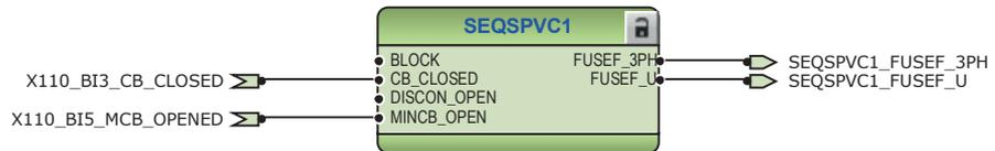
Abb. 74: Funktion für die Automatenfallüberwachung
