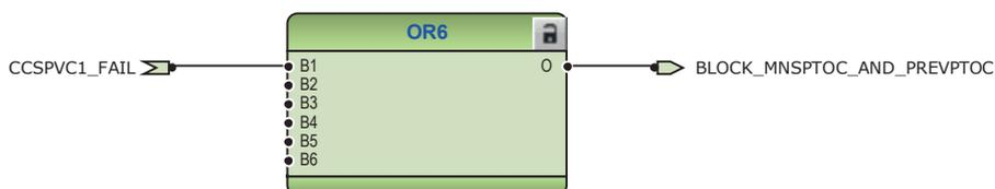
Abb. 202: Blockierlogik für Drehfeldüberwachung und Schieflastschutz
