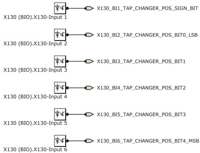
Abb. 181: Binäreingänge - X130 Klemmleiste
