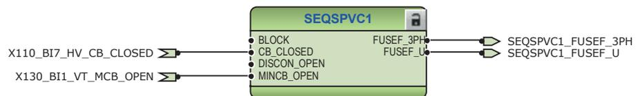
Abb. 355: Funktion für die Automatenfallüberwachung auf Oberspannungsseite
