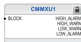
Abb. 270: Strommessung: Dreiphasige Stromanzeige (OS)
