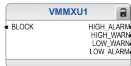
Abb. 372: Spannungsmessung: Spannungsanzeige (Oberspannungsseite)
