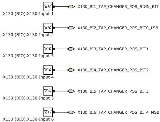
Abb. 139: Binäreingänge - X130 Klemmleiste
