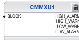
Abb. 48: Strommessung: Dreiphasige Strommessung (Oberspannungsseite)
