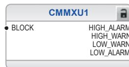
Abb. 174: Strommessung: Dreiphasige Strommessung (Oberspannungsseite)
