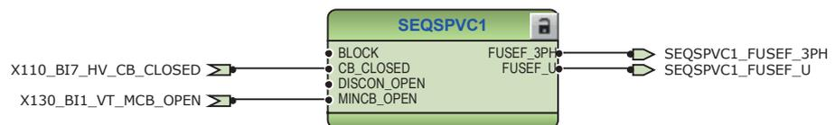
Abb. 307: Funktion für die Automatenfallüberwachung auf Oberspannungsseite
