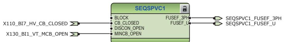
Abb. 207: Funktion für die Automatenfallüberwachung
