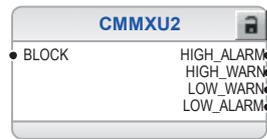
Abb. 369: Strommessung: Dreiphasige Strommessung (Unterspannungsseite)
