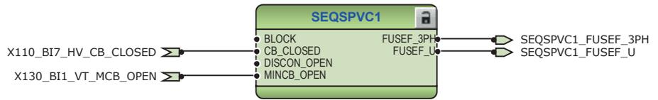
Abb. 257: Funktion für die Automatenfallüberwachung auf Oberspannungsseite
