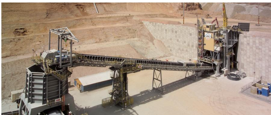
不同输送带具有不同的特性，输送带的长度短则几米，长则数千米，而且皮带可水平或倾斜布置。通常来说，皮带输送机具有恒定的负载转矩和随负载由低到高变化的制动转矩。通过使用ABB软起动器，可以使起动转矩降至能够起动输送带的最小转矩。软起动器的宽幅参数设置范围使用户可以更精确地调节转矩以满足起动要求，最大限度降低维护成本。
