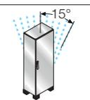
Protezione contro la penetrazione di gocce d'acqua in caduta fino a 15° rispetto all'asse verticale
