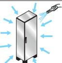
Protezione contro la penetrazione di getti d'acqua della portata delle onde marine
