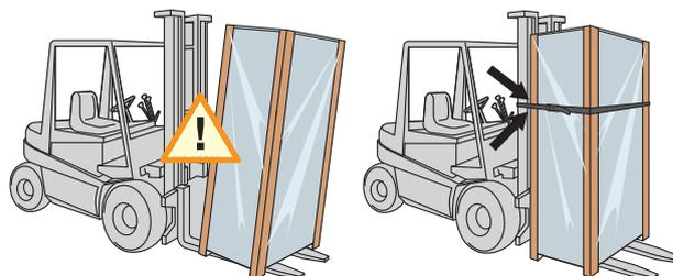
Nel caso di strutture L=800mm (con vano cavi interno o esterno) contenenti sistema di barre, verificare il baricentro prima della movimentazione.
