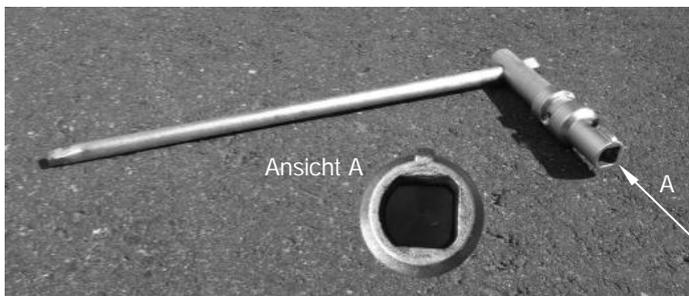
Abb. 4.2.2.2: Aufnahme des kodierten Schalthebels für die Betätigung der Spannweite des Federspeichers (schwarze Markierung auf der Welle)
