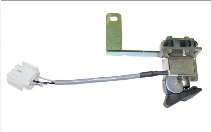
Le solénoïde d'ouverture **(-MO3)** est un déclencheur spécial à démagnétisation pour accouplement à un relais contre les surintensités, de type auto-alimenté. Il est monté dans la commande (sur le côté gauche) et il n'est pas en alternative au déclencheur d'ouverture supplémentaire **(-MO2)**.
