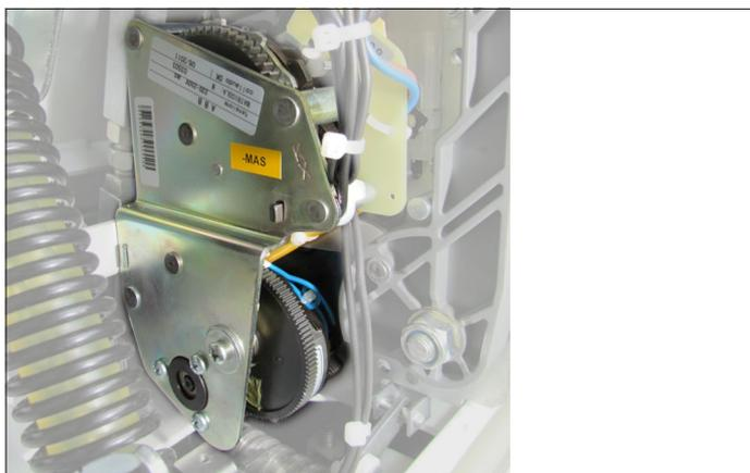
Réalise la charge automatique des ressorts de fermeture de la commande du disjoncteur.
