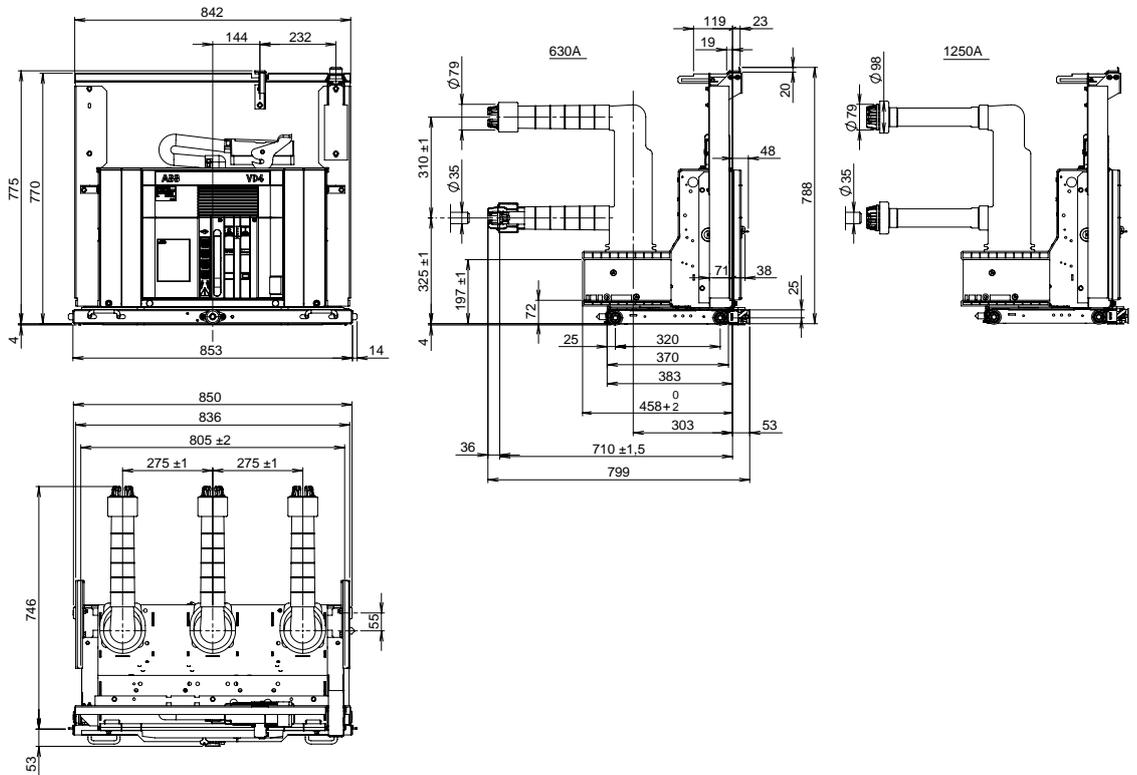
**Disjoncteurs débrochables pour tableaux UniGear ZS1 et modules PowerCube PB4**
