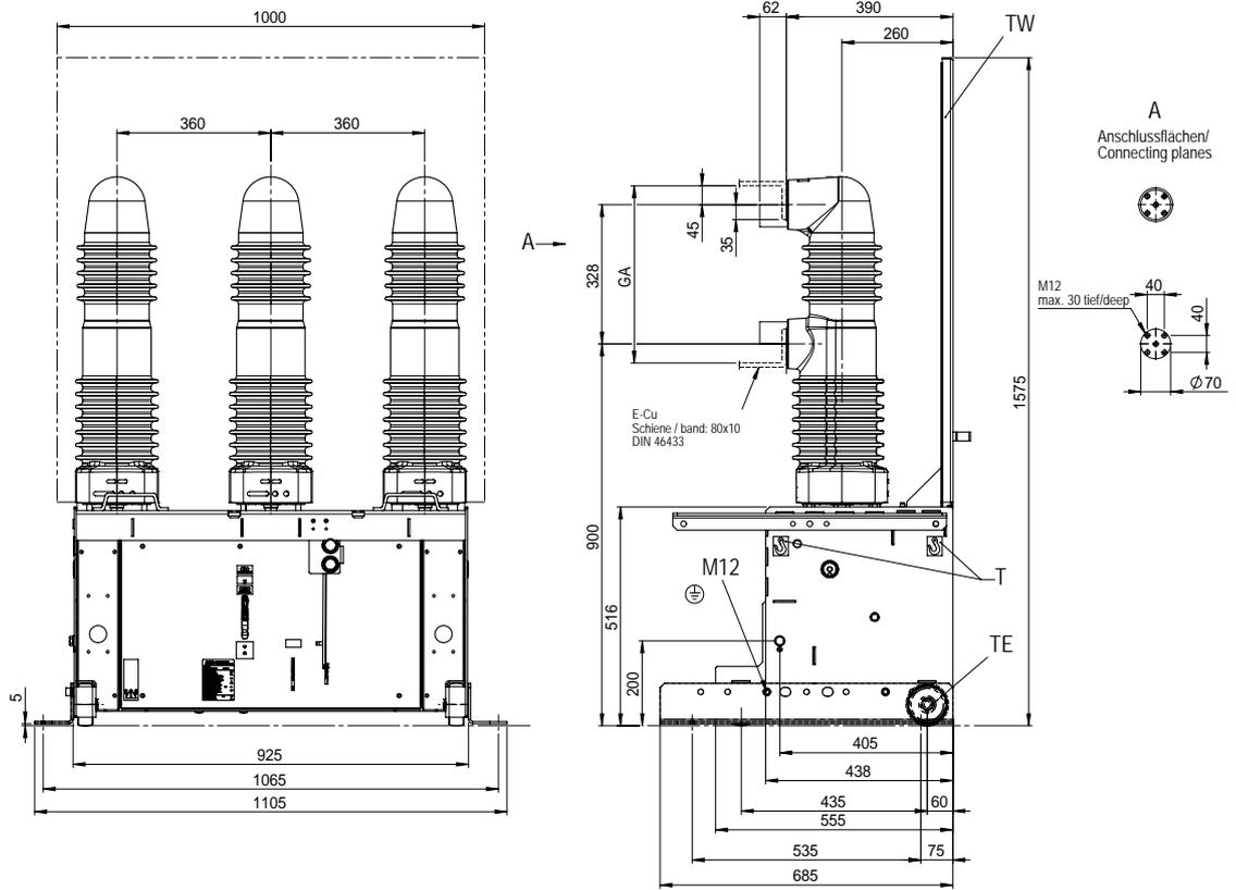
**Disjoncteurs débrochables pour tableaux UniGear ZS1 et modules PowerCube PB1**
