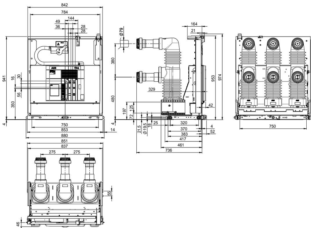
(\*) Le courant ininterrompu nominal de 2300 A est garanti avec ventilation naturelle. Le courant ininterrompu nominal de 2500 A est garanti avec ventilation forcée.
