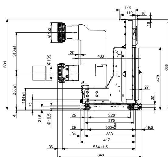
**Disjoncteurs débrochables pour tableaux UniGear ZS1**
