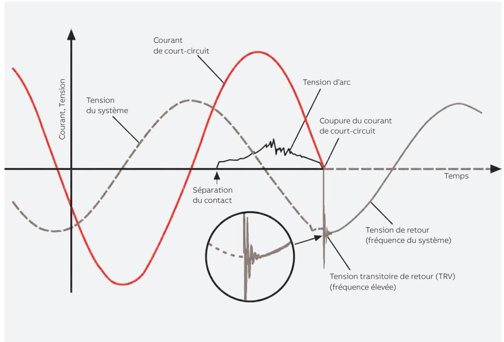
Evolution des courbes du courant et de la tension dans une phase pendant l'interruption sous vide.
