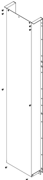
Abbildung 74. Schrauben des vertikalen Kanals und der unteren Platte
