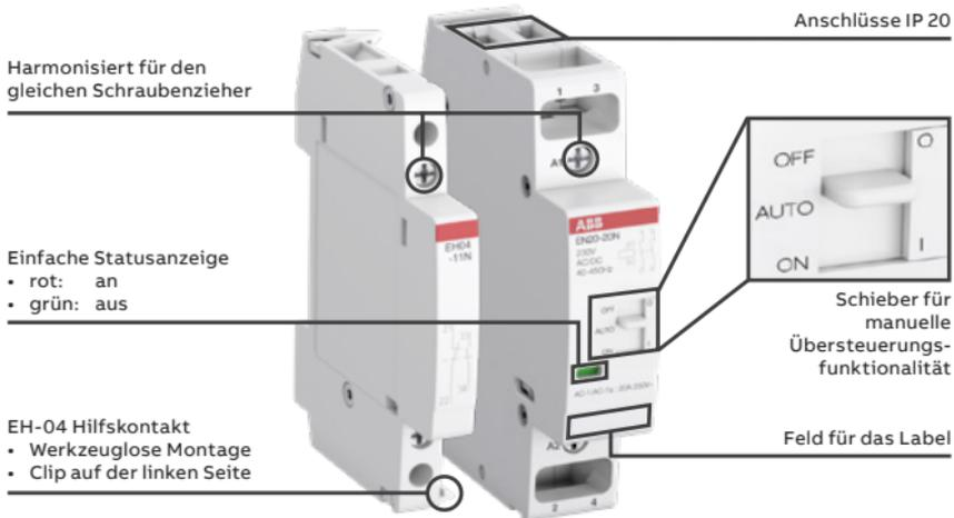
Die Installationsschütze von ABB umfassen eine Vielzahl von Funktionen, die die Installation und Wartung erleichtern. Eine mechanische Anzeige zeigt den Status in grün oder rot an, um die Systemdiagnose zu beschleunigen.
