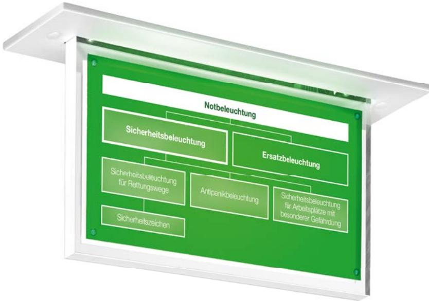
Abbildung 01: Übersicht der Not- und Sicherheitsbeleuchtung
