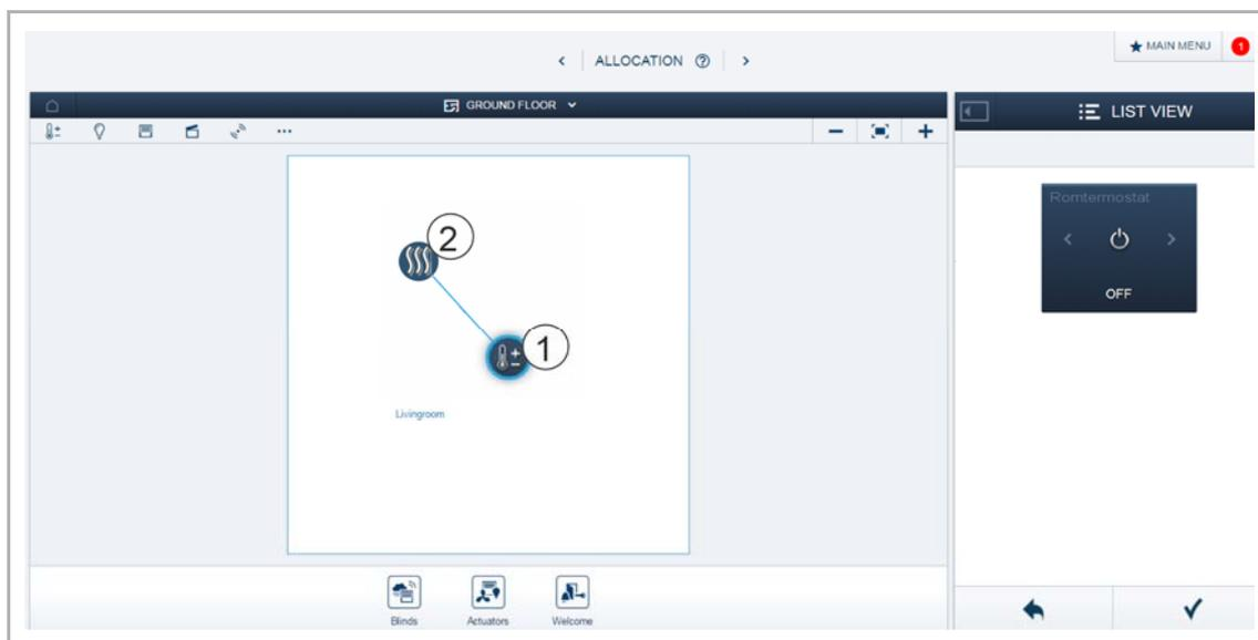
Fig. 19 : Liaison entre actionneur et capteur
