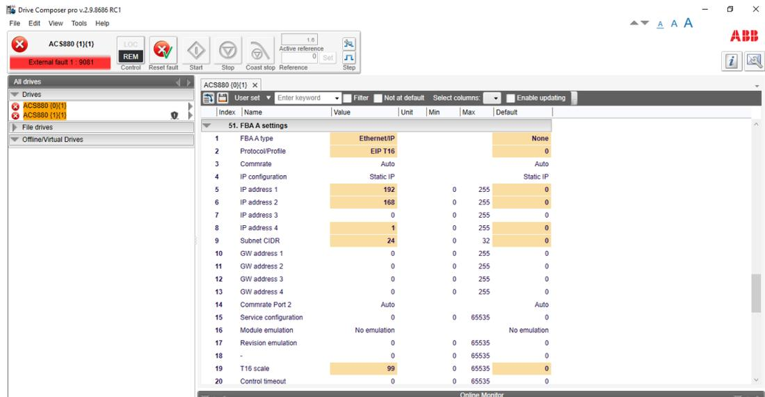
4. Refresh the fieldbus adapter in parameter **51.27 FBA A par refresh**.
