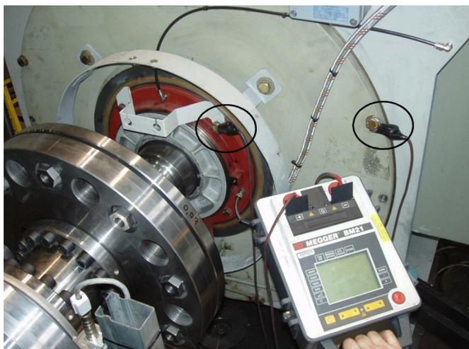
Рисунок 28 Измерение сопротивления изоляции роликового подшипника
