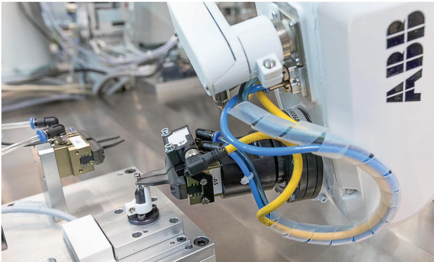
Arbeitet präzise mit einer Positionsgenauigkeit von einem hundertstel Millimeter: der IRB 120 von ABB.
