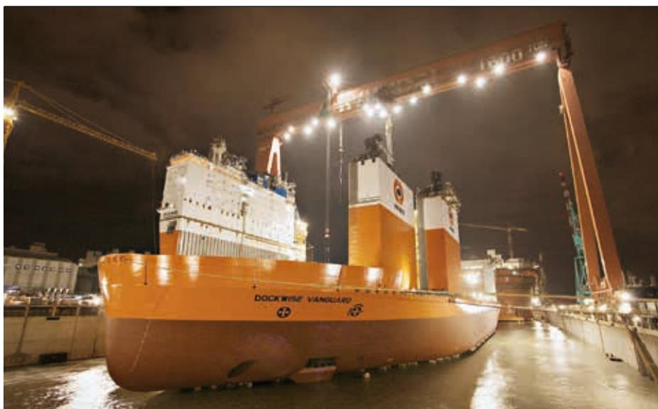
**M**it einer Tragfähigkeit von 117.000 t, einer Länge von 275 m und einer Breite von 70 m verfügt die Dockwise Vanguard über einzigartige Fähigkeiten zum sicheren Transport von übergroßen
