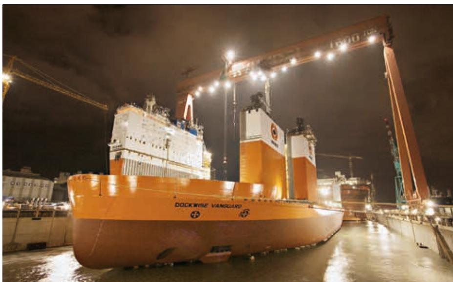
Long de 275 mètres pour une largeur de 75 mètres, ce mastodonte est capable de transporter 117 000 tonnes pour convoier en toute sécurité à travers le monde des plates-formes pétrolières, des unités de production et de stockage flottantes, ou encore des navires de forage → 1. Il peut
