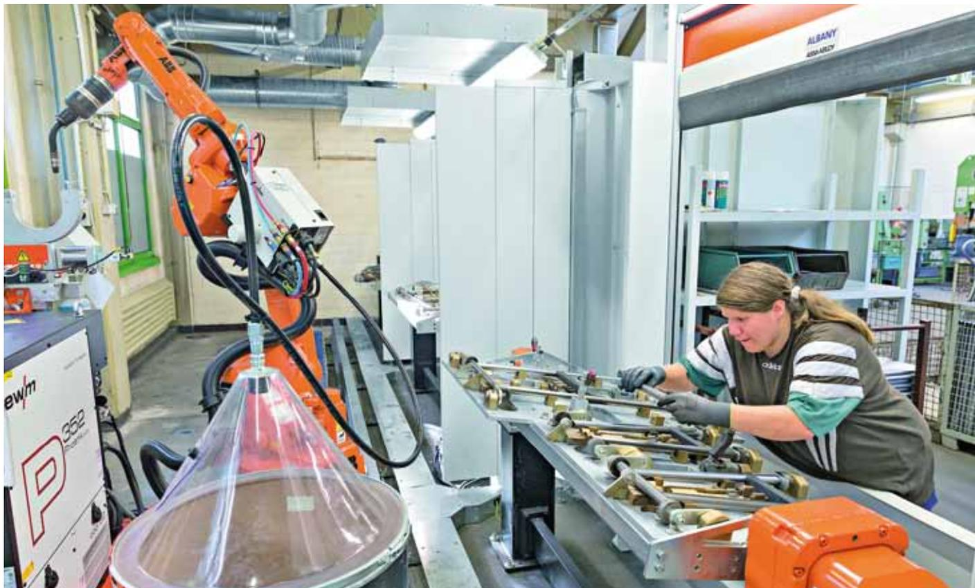
Eine Werkerin bestückt die Schweißvorrichtung mit den Einzelteilen und verspannt sie, bevor der Schweißvorgang freigegeben wird.
