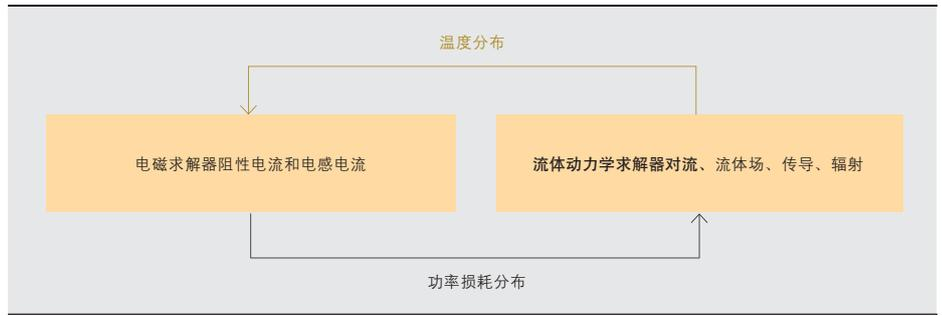
6 低压母线系统的电磁耦合 / 热计算
