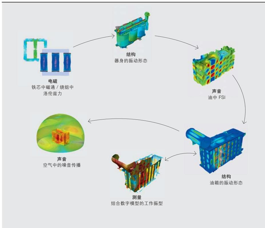
物理场软件，能让用户的研究详细而高效，显示出设计参数之间复杂的相互作用，以及材料性能对噪声功率级的影响。正确的相关数字模型构成了“虚拟样机”的基础，这意味着能对产品和系统进行虚拟地测试和改进，不必生产“有形”样机。这种数字仿真并不常见，但从根本上讲，它是减少噪音污染和确保供电连续性措施的一部分，让客户在即使发生地震的情况下也能安心地工作和睡眠。
