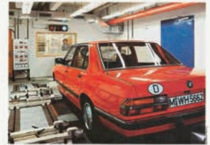
Banc d'essai à quatre rouleaux pour véhicules à quatre roues motrices
