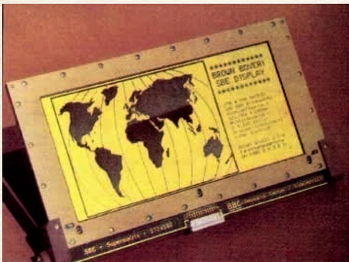
Prototype d'écran LCD à matrice passive de 540 x 270 pixels, breveté BBC
