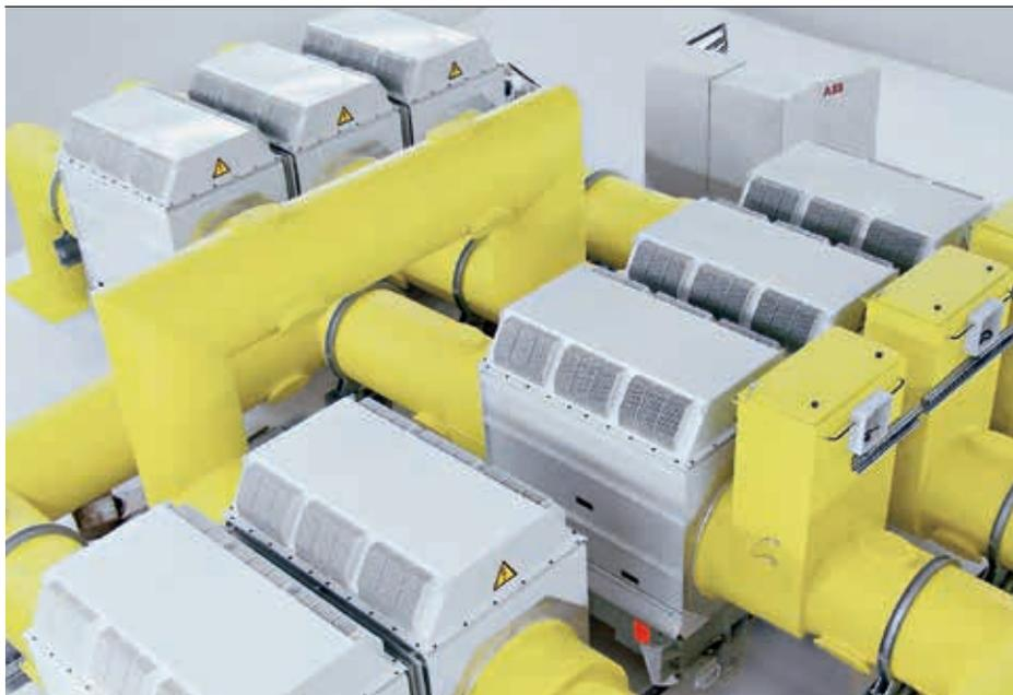
Les disjoncteurs d'alternateur qui équipent les centrales thermiques ou nucléaires, à gaz ou à cycle combiné, ou encore les centrales hydroélectriques ou stations de transfert d'énergie par pompage (STEP) → 1 sont mis à rude épreuve. En fonctionnement normal, ils doivent laisser passer le courant assigné total de l'alternateur, qui atteint facilement 23 kA sans refroidissement, voire plus de 30 kA en cas de refroidissement actif, sous des tensions allant jusqu'à 32 kV.
