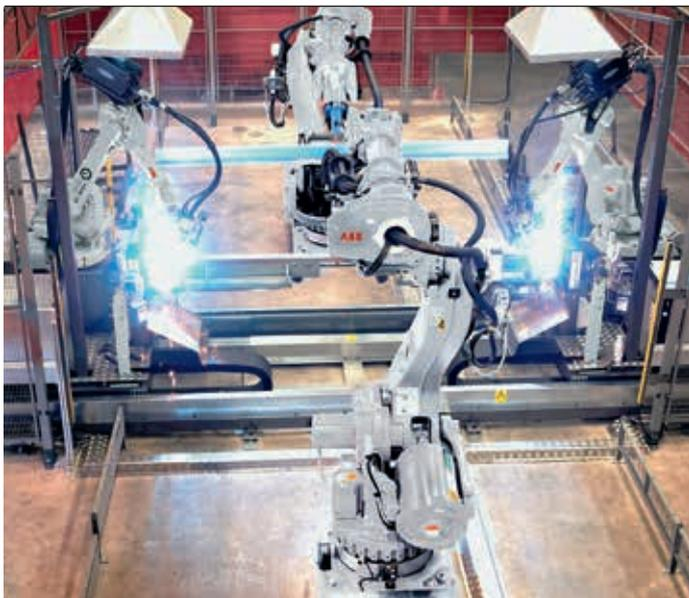
simples. S'agissant d'une solution clé en main, FlexArc peut être déplacée au sein d'un même site ou entre différents sites. Les ingénieurs peuvent ainsi concevoir un outil de production hautement flexible qui s'adapte rapidement à tout changement de campagne.
