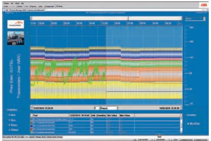
ABB cpmPlus Energy Manager modelliert und visualisiert die Energieflüsse der gesamten Anlage und berechnet optimale Pläne für die Verteilung der Nebenproduktgase an die Verbraucher.
