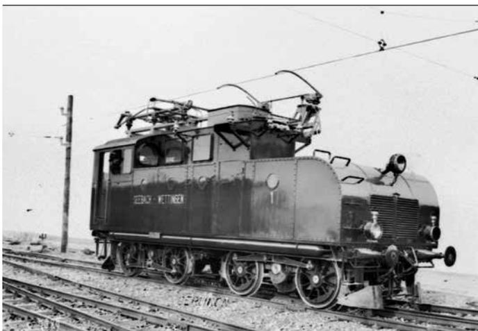
4 MFO-Versuchslok Nr. 2 mit Einphasen-Antriebsmotoren
