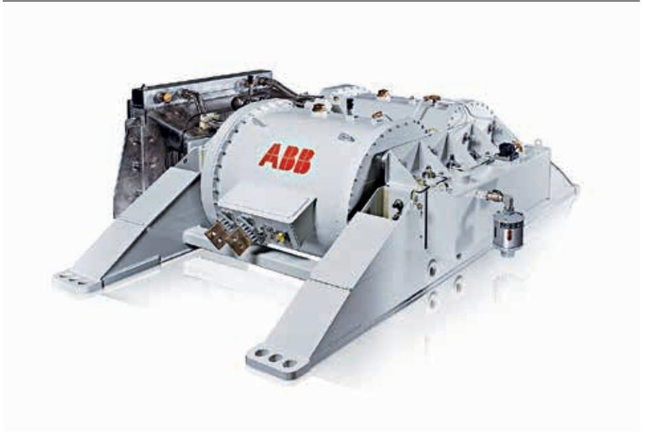
Ben Ölkessel und die damit verbundenen Einschränkungen benachteiligt ist. Für Effilight hat ABB jedoch ein hybrides Transformator-Konzept entwickelt, bei dem sich die Wicklung in einem kleinen Ölkessel befindet, während der Kern von Luft umgeben ist.
