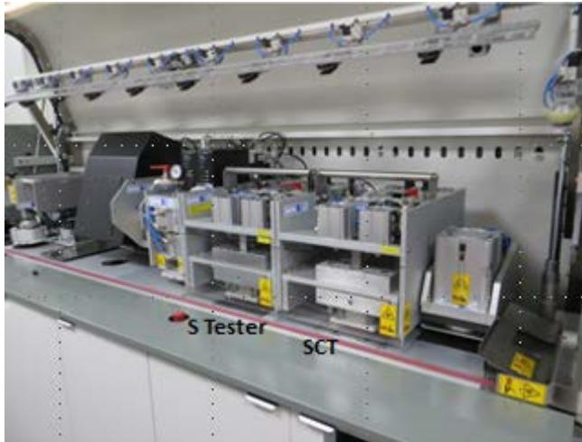
Fig 19. S-Test module in L&W Autoline
