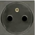
Bipolar normal con T.T. sistema francés                    | N2287 BL<br>AN<br>PL | 16 A / 250 V~<br>T.T. de espiga saliente. Para conexión polarizada Con sistema de seguridad que impide contactos directos involuntarios. |
