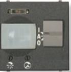
Detector de movimientos de empotrar | N2241 BL<br>AN<br>PL | 230 V~ ; 50 Hz<br>☉: 1.800 W<br>☉☉☉☉☉☉☉ 750 VA<br>☉☉☉☉☉☉☉☉ 400 VA<br>Salida de relé libre de potencial: 2 bornes<br>Controlable a través de pulsadores auxiliares (N2X04)<br>Umbral de luminosidad regulable<br>Retardo de desconexión: 10 seg- 10 min<br>Alcance de detección: max 5 metros en un ángulo de 110°<br>Selector frontal para el modo de funcionamiento (siempre encendido, automático ó siempre apagado) |
