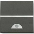
Interruptor temporizado | N2262 BL<br>AN<br>PL   | 230 V~ ; 50 Hz<br>☉: 1000 W<br>☉☉☉☉ 1000 VA cos φ = 0,6<br>☉☉☉☉☉ 650 VA<br>Temporizador:<br>10 seg. a 10 min.<br>Protección fusible T5A<br>Con borna de control remoto para pulsadores convencionales (N2X04.5) y visor de orientación nocturna. |
