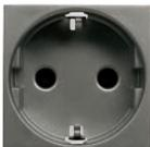
Bipolar con T.T. lateral Schuko automático               | N2288.6 BL<br>AN<br>PL | 16 A ; 250 V~<br>Conexión rápida sin tornillos. Cada borna admite cable flexible hasta 2 x 2,5 mm <sup>2</sup> o hilo rígido hasta 2 x 4 mm <sup>2</sup> . Reduce los tiempos de instalación en un 40%. Con sistema de seguridad que impide contactos directos involuntarios |
