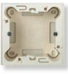
Zócalo de 1 y 2 módulos                   | N2991 BL   | Para 2 mecanismos de 1 módulo ó 1 de 2 módulos.<br>Para placas de 85 x 85 mm.<br>(Alto x Ancho) ref. N2271 XX<br>Entradas precortadas en los 4 lados para adaptadores N2999 y para los siguientes adaptadores unex y canaletas:<br>- 78672 (10 x 22)<br>- 78673 (10 x 30)<br>- 78681 (16 x 16)          |
