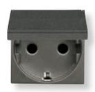
Bipolar con T.T. lateral Schuko con tapa                 | N2288.1 BL<br>AN<br>PL | 16 A ; 250 V~<br>Con sistema de seguridad que impide contactos directos involuntarios. Tapa con sujeción. Pensado para lugares próximos a fuentes de suciedad como cocinas. Apertura de la tapa 180°                                                                         |
