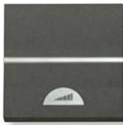
Regulador electrónico de pulsación. | N2260 BL<br>AN<br>PL   | 230 V~ ; 50 Hz<br>☉: 40 - 450 W<br>☉☉☉ 40 - 400 VA.<br>Con borna de control remoto para pulsadores convencionales (N2X04.5) y visor de orientación nocturna. |
