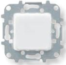
Piloto de balizado | 8181.2 | 230 V~ ; 50 Hz<br>Flujo luminoso > 2 lúmenes a 1m.<br>Autonomía: 3h. 1h a máxima iluminación y 2h a menor iluminación. Batería de Níquel-Metal-Hidruro (Ni-MH).<br>Tapa ref. 5581 |
