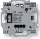
Interruptor temporizado de relé    | 8130.1 | 230 V~ ; 50 Hz<br>127 V~ ; 60 Hz,<br>2300 W / VA ; 10 AX a 230 Vac<br>Válido para todo tipo de cargas.<br>Temporizador: 30 - 300 seg.<br>Borna de conexión a pulsadores (8104.X)<br>Teclas ref. 5530                                        |
