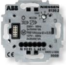
Interruptor temporizado de 2 relés | 8130.2 | 230 V~ ; 50 Hz<br>127 V~ ; 60 Hz<br>2 x 700 W / VA ; 3 AX a 230 Vac<br>Válido para todo tipo de cargas. Con fluorescentes usar contactores.<br>Temporizador: 30 - 300 seg.<br>Bornas de conexión de pulsadores (8104.X)<br>Teclas ref. 5530 |
