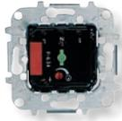
Interruptor temporizado de relé | 8162   | 230 V~ ; 50 Hz<br>Temporización de 10 seg. a 10 min.<br>☼ 1000 W<br>☼ 1000 VA cos φ = 0,6<br>☼ 650 VA<br>Para fluorescentes.<br>Protección fusible T5 A.<br>Con borna de control remoto para pulsadores convencionales (8104.5) y led de orientación.<br>Tecla ref. 5562 |
