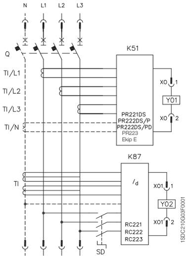
Трехполюсный или четырехполюсный автоматический выключатель с электронным распределителем защиты PR221DS, PR222DS/P, PR222DS/PD, PR223 или Ekip E и распределителем защиты дифференциального тока RC221, RC222 или RC223 (только для четырехполюсных Т4, Т5 и Т6)
