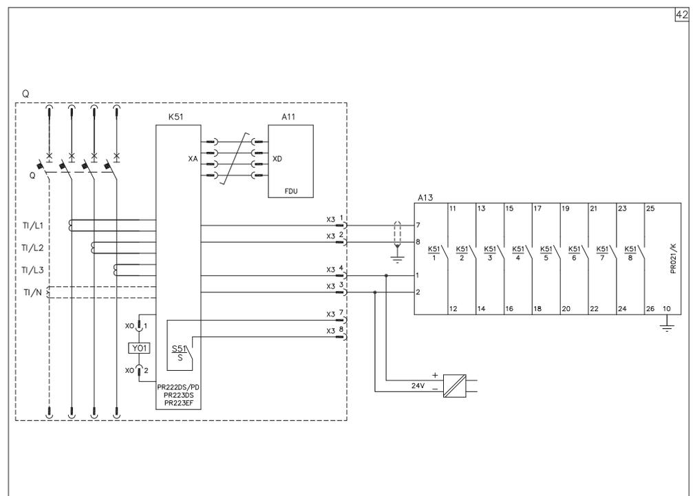
**Электронный расцепитель защиты PR222DS/PD, PR223DS или PR223EF с подключенными блоком дисплея передней панели FDU и блоком сигнализации PR021/K**
