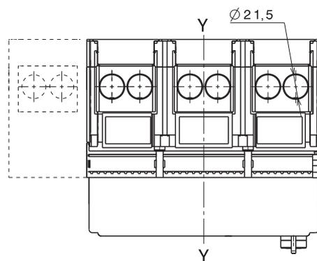
Передние выводы для кабелей FC CuAl —  $4 \times 240 \text{ мм}^2$
