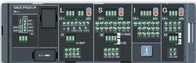
Расцепители защиты PR231 и PR232, с DIP-переключателями для регулировки порогов срабатывания каждой защитной функции снабжены светодиодами, сигнализирующими о срабатывании защиты: это означает, что всегда может быть выявлена причина срабатывания автоматического выключателя.
