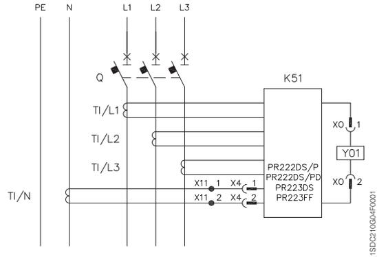
Трехполюсный автоматический выключатель стационарного исполнения с трансформатором на нейтральном проводнике, вне автоматического выключателя (для Т4, Т5 и Т6)
