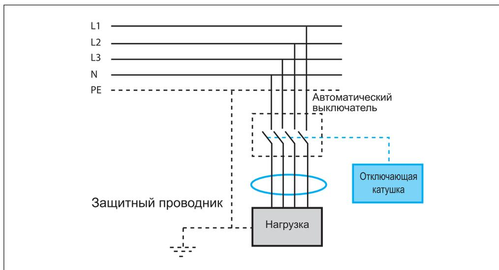
Принцип работы расцепителя токов утечки на землю делает его пригодным для распределительных систем TT, IT (ей следует уделить особое внимание) и TN-S, но не для систем TN-C. Фактически, в этих системах нейтраль также используется в качестве защитного проводника, что делает невозможным определение дифференциального тока, даже если бы нейтраль (называемая PEN в этих распределительных системах) проходила через тороид, так как векторная сумма токов была бы всегда равной нулю.
