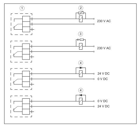
1) Relay outputs; 2) Varistor; 3) RC filter; 4) diode
