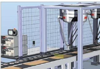
Das Picking PowerPac ist ein Offline-Simulationstool für PickMaster 3 zur Simulation von Pick & Place-Anwendungen. Mit dem Picking PowerPac kann die Leistung von Pick & Place-Linien durch eine vorgeschaltete, virtuelle Optimierung gesteigert werden – bevor die Linie tatsächlich in Betrieb geht.
