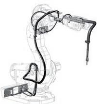
Extern geführtes DressPack für Fertigungsanlagen mit geringen Anforderungen an die Flexibilität, geeignet für einfache Werkzeuge. Die Anzahl der zu übertragenden Signale ist limitiert mit eingeschränkten Möglichkeiten zur Offline-Programmierung. Individuelle Justagen des DressPacks können erforderlich sein.
