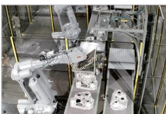
Mittels Conveyor Tracking kann der Roboter einem Werkstück auf einem laufenden Förderband folgen. Während der Roboter dem Förderband folgt, wird die programmierte TCP-Geschwindigkeit relativ zum Werkstück beibehalten, auch wenn die Förderband-Geschwindigkeit sich leicht verändert.
