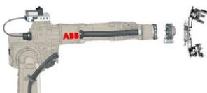
Das Tool System für den IRB 2600ID liefert Druckluft, Strom und Anwendersignale an einen am Roboterflansch montierten Greifer. Alle Leitungen sind im Inneren des Roboter-Oberarms geführt und somit bestens geschützt. Ein optional erhältlicher Werkzeugwechsler erhöht die Flexibilität, wenn mehrere unterschiedliche Werkzeuge eingesetzt werden. Hauptvorteil des Tool Systems ist, dass es keinerlei Einschränkung der Roboterbewegung gibt.
