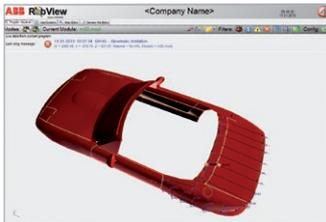
Mit RobView 5 können Anwender ihre Lackieranlage steuern, den kompletten Lackierprozess visualisieren sowie ihre Roboterlackierzelle bedienen und überwachen. Eine Grundversion von RobView 5 wird mit allen IRC5P-Steuerungen kostenfrei mitgeliefert (Freischaltung erforderlich). Die Software ist individuell anpassbar und mit Plug-In-Optionen für große und moderne Anlagen erweiterbar.
