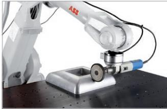
Üblicherweise sind Roboter positionsgesteuert mit einer vordefinierten Bahn und einer festgelegten Geschwindigkeit. Mit Integrated Force Control reagiert der Roboter auf seine Umgebung und weicht basierend auf Rückmeldungen des Kraftsensors von der programmierten Bahn oder der vorgegebenen Geschwindigkeit ab.
