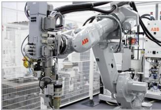
Die Option RobotWare Dispense bietet Unterstützung für verschiedene Prozesse beim Materialauftrag, wie z. B. Kleben und Versiegeln. Diese Option bietet schnelle und präzise Positionierung kombiniert mit einer flexiblen Prozesssteuerung. Die Kommunikation mit der Ausrüstung zum Materialauftrag erfolgt über digitale und analoge Ausgänge.
