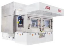
Die FlexWasher-Standardzellen sind das ideale Produkt für das Waschen und Entgraten von Gussteilen. Im Inneren der Zelle arbeitet ein ABB-Roboter in Foundry-Prime-Ausführung, der Reinigungsmitteln und 100% Luftfeuchtigkeit standhält. Die Zellen sind in verschiedenen Größen und Ausführungen lieferbar. Sie können entweder manuell, über ein Förderband oder durch einen Industrieroboter beladen werden.
