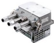
Die Air Control Unit (ACU) ist ein leistungsfähiger, kosteneffizienter Luftstromregler für den Einsatz in Großserien-Lackieranwendungen. Diese extrem präzise und zuverlässige Einheit steuert den für eine Lackierpistole oder Lackierglocke bestimmten Luftstrom und enthält drei verschiedene Kanäle, die das Sprühmuster, die Glockenrotation und sogar den Lackdurchfluss für einige Applikationen steuern.
