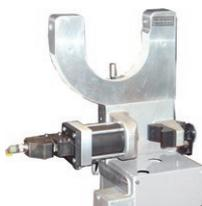
BullsEye bietet dem Anwender eine vollautomatische Bestimmung des Tool Center Points (TCP) und ermöglicht somit den höchstmöglichen Nutzungsgrad des Robotersystems. Anpassbare, vordefinierte Programme gestatten eine vollautomatische Bestimmung, regelmäßige Kontrolle und Korrektur des TCP während der laufenden Produktion, was Stillstandszeiten annähernd gegen Null gehen lässt.
