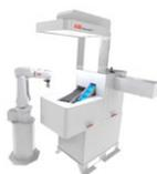
Das FP-100-Funktionspaket eignet sich für die automatische Zuführung und Handhabung von kleinen, unsortierten Werkstücken. Diese werden auf das Pufferband des FP 100 gelegt und über einen Wendelförderer auf das Kameraband vereinzelt. Das Vision-System erkennt die Position der Werkstücke und führt dann den Roboter zur Greifposition. Das Funktionspaket ist ideal geeignet, wenn es auf kurze Zykluszeiten ankommt.
