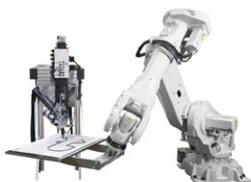
Das automatisierte Auftragen von Klebstoffen oder Dichtmitteln durch Roboter erfordert ein perfektes Zusammenspiel von Dosiersystem und Robotersteuerung. Beide Systeme müssen absolut synchron arbeiten, um eine hohe Performance und konstante Qualität zu erreichen. Das Integrated Dispensing Function Package integriert daher die Steuerung des Dosiersystems vollständig in die Robotersteuerung IRC5.
