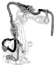
Extern geführtes DressPack mit Rückzugsarm, der die Kabel vom Handgelenk wegzieht. Individuelle Justagen des DressPacks können erforderlich sein.
