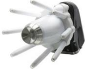
Der Zerstäuber mit Außenaufladung ist hocheffizient im Einsatz mit wasserbasierten Lacken. Er arbeitet mit bis zu 70.000 Umdrehungen pro Minute und mit einem Farbdurchfluss von 700 ml/min im Primer. Wie die anderen Zerstäuber der RB1000i-Serie ist auch der RB1000i-EXT mit Sensoren ausgerüstet und mit der digitalen ABB Ability™-Plattform vernetzt.
