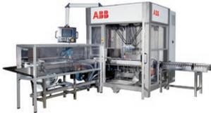
RacerPack ist eine Lösung für das Verpacken von Produkten in Schlauchbeuteln und das anschließende Ablegen der verpackten Produkte in Kartons. Diese Lösung beinhaltet die Produktzuführung, die Roboterzelle mit Greifern sowie das Auslaufförderband.
