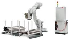
Das FP-800-Funktionspaket ist für das Greifen von röhrenförmigen Werkstücken konzipiert. Anstatt traditioneller 2D- oder 3D-Kameratechnik, kommt beim FP 850 ein Lasersensor zum Einsatz, der in den Greifer integriert ist und den Roboter so zum Werkstück führt. Der Vorteil ist, dass weniger Hardware (wie beispielsweise ein PC oder eine Kamerahalterung) benötigt wird.
