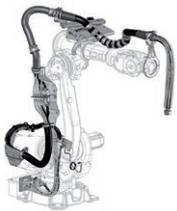
Extern geführtes DressPack mit Rückzugsarm, der die Kabel vom Handgelenk wegzieht. Individuelle Justagen des DressPacks können erforderlich sein.
