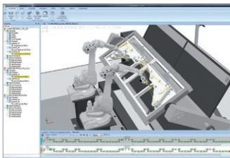
Das ArcWelding PowerPac ist ein Add-In zur schnellen und einfachen Programmierung von Lichtbogenschweiß-Applikationen. Es beinhaltet das Expertensystem VirtualArc, mit dem Prozessparameter zur Erreichung eines bestimmten Schweißergebnisses festgelegt werden können. Die Verwendung von ArcWelding PowerPac erleichtert es, stets optimale Anstellwinkel des Werkzeugs und damit qualitativ hochwertige Schweißnähte und kürzere Zykluszeiten zu erreichen.
