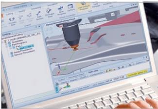
Das RobotStudio Cutting PowerPac ist das Offline-Programmierwerkzeug, das dem Bediener die Erstellung, Änderung und Überprüfung von Schneidprogrammen in einer 3D-Simulation erlaubt. RobotStudio Cutting PowerPac ist nahtlos integrierbar in RobotWare Cutting.
