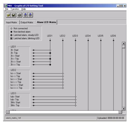
Fig. 6.4.1.3.-1 Alarm LED Matrix
