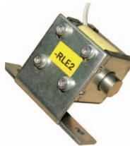
Magnete di blocco sul carrello: questo accessorio impedisce l'inserimento dell'interruttore nel quadro con la presa dei circuiti ausiliari disinserita. Essendo la presa dotata di un blocco all'inserimento per correnti nominali diverse, il magnete di blocco indirettamente impedisce di inserire interruttori con correnti nominali inferiori a quelle previste nell'unità funzionale.
