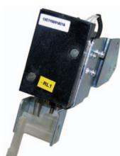
Magnete di blocco sul comando di chiusura: se disalimentato impedisce meccanicamente la chiusura dell'interruttore.
