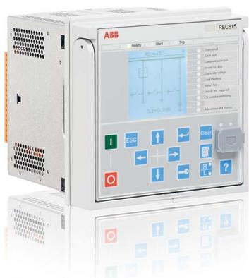
Il dispositivo è progettato per il controllo remoto; sono quindi disponibili i protocolli IEC 60870-5-104, IEC 60870-5-101, Modbus®, DNP3. Fornisce, infine, in modo nativo lo standard IEC 61850 e supporta i messaggi GOOSE. Una seconda porta di comunicazione consente, inoltre, di realizzare una rete ridondante.
