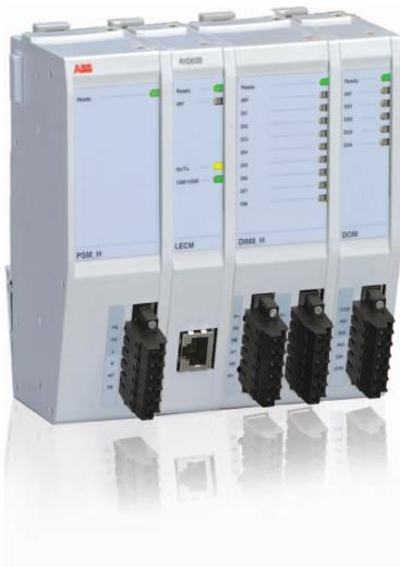
Le unità RIO600 sono delle unità modulari di ingresso/uscita, analogiche e digitali, che consentono di espandere la capacità di controllo del REC 615. RIO600 consente comunque di connettere i sensori combinati di corrente/tensione e di ricevere misure analogiche al fine di migliorare il monitoraggio e il controllo di tutte le apparecchiature della cabina secondaria.
