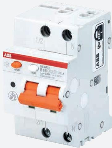
DS-ARC1 ist der neue 1P+N AFDD mit integriertem FI/LS-Schutzschalter, bei einem Bemessungsschaltvermögen von 6 kA und 10 kA. Mit einer Breite von nur drei Teilungseinheiten, bietet der DS-ARC1 einen vollständigen Schutz vor Fehlerlichtbögen, Überspannung (für AFDD intern), Überstrom und Fehlerstrom gegen Erde.
