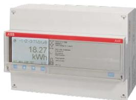
Conexión conector CTVT, 1(6) A. Con valores de medición y función de alarma. Para conexión de 3 y 4 conductores. Comunicación: interfaz de infrarrojos. Interfaces opcionales: bus M, RS-485 (Modbus o EQ-Bus ajustable). Ancho: 7 módulos DIN. Comprobado y autorizado según MID e IEC.
