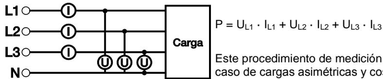
Este procedimiento de medición es muy preciso, incluso en caso de cargas asimétricas y  $\cos \varphi$  bajo.
