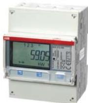
Conexión directa hasta 65 A. Con valores de medición y función de alarma. Para conexión de 3 y 4 conductores. Comunicación: interfaz de infrarrojos. Interfaces opcionales: bus M, RS-485 (Modbus o EQ-Bus ajustable). Ancho: 2 módulos DIN. Comprobado y autorizado según MID e IEC.
