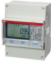
Conexión conector CT, 1(6) A. Con valores de medición y función de alarma. Para conexión de 3 y 4 conductores. Comunicación: interfaz de infrarrojos. Interfaces opcionales: bus M, RS-485 (Modbus o EQ-Bus ajustable). Ancho: 2 módulos DIN. Comprobado y autorizado según MID e IEC.
