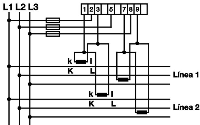
El mismo uso es posible en una red de cuatro conductores. Para ello deben estar conmutados los convertidores de corriente en L1, L2 y L3. Debe garantizarse que los convertidores de corriente estén conectados con la polaridad correcta ( $K1 \rightarrow L1$ ,  $k1 \rightarrow l1$ )
