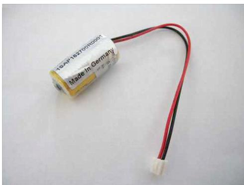
4. Insérer le connecteur de la pile dans le port connecteur du circuit imprimé. La conception du connecteur assure une polarité correcte (rouge = pôle positif = côté droit).
