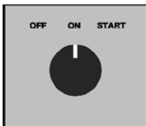
**Interruttore di comando (solo unità dotate di contattore principale)**
