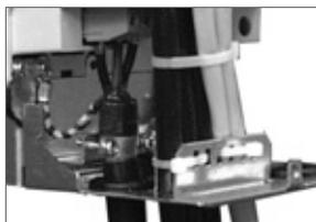
Den Deckel des Anschlusskastens befestigen.
