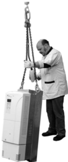
*Heben eines Geräts der Baugröße R6*
