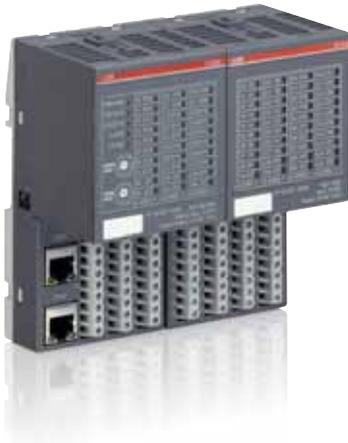
Módulos de E/S flexibles para el potente PLC AC500
