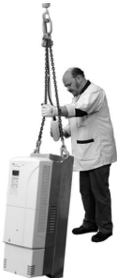
*Elevación de una unidad con bastidor R6*
