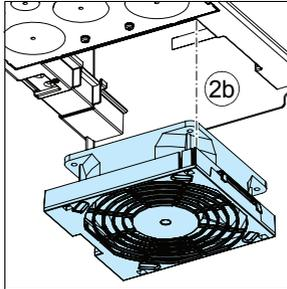
3. Die Lüfterbaugruppe in umgekehrter Reihenfolge installieren.
