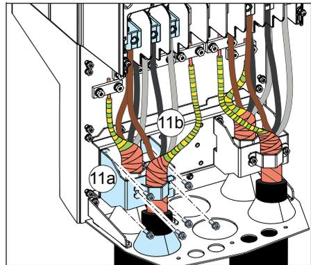
12. Die Erdungsschiene für die Steuerkabel installieren.
