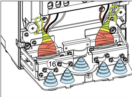
18. Die Kabel außerhalb der Einheit mechanisch sichern.
