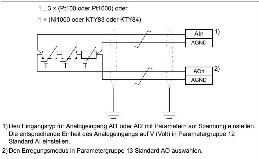
**⚠️ WARNUNG!** Da die oben gezeigten Eingänge nicht gemäß IEC 60664 isoliert sind, erfordert der Anschluss des Motortempersensors eine doppelte oder verstärkte Isolation zwischen spannungsführenden Teilen des Motors und dem Sensor. Wenn die Ausführung die Anforderungen nicht erfüllt, müssen die Klemmen der E/A-Karten vor Berührung geschützt und dürfen nicht an andere Geräte angeschlossen werden oder der Temperatursensor muss von den E/A-Klemmen getrennt werden.
