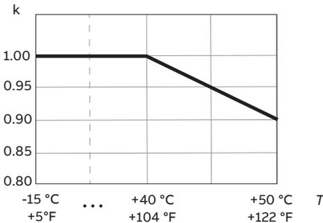
IP21 (UL Type 1) 传动型号 -078A-4; -099A-6、-125A-6、-144A-6
