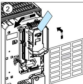
3. 拆下电机电缆橡胶护套、输入动力电缆橡胶护套，以及制动电阻电缆橡胶护套（如有）。连接控制电缆时，拆下控制电缆的橡胶护套。
