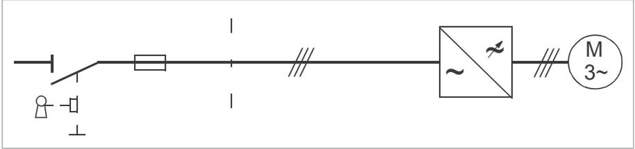
根据当地的输入电缆保护法规为熔断器或断路器选型。根据技术数据中给出的说明，选择传动的熔断器或断路器。在传动内部短路的情况下，用于保护传动的熔断器将会限制传动的损坏程度并避免损坏临近的设备。
