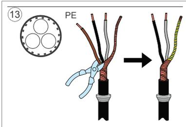
14. 按照电机电缆连接方式连接电缆，见步骤7。将屏蔽层 360 度接地（14a）。将绞线屏蔽层连接到接地端子（14b）上，将导线连接到 R+ 和 R- 端子（14c）上，并拧紧到表格给出的力矩。
