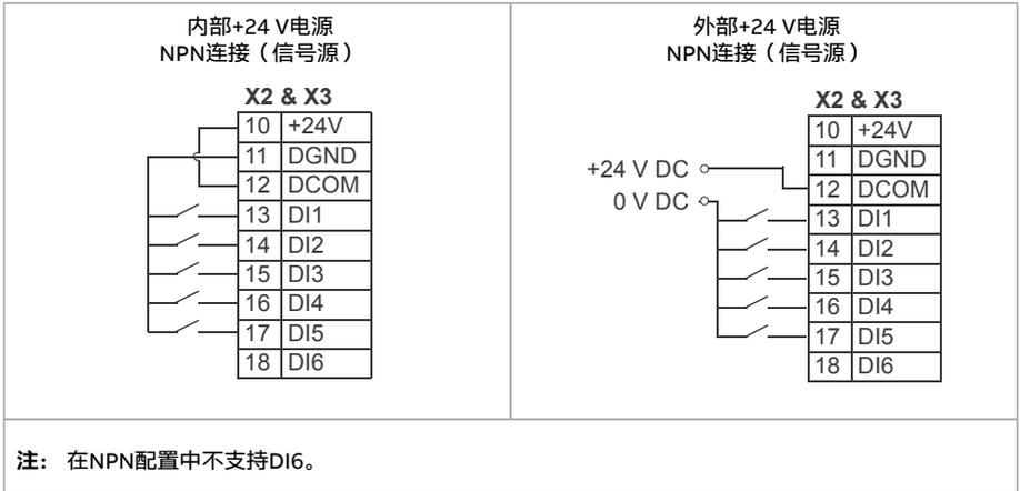
**警告!** 如果使用外置+24 V AC 电源为控制板供电，请勿将 +24 V AC 电缆连接到控制板接地。
