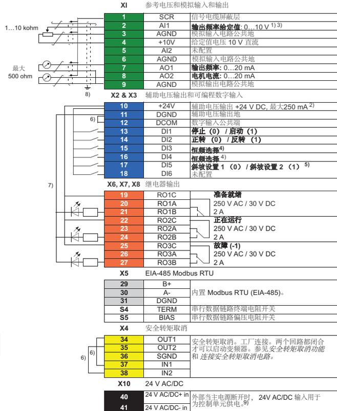
辅助电压输出 +24 V (X2:10) 的总负载能力为 6.0 W (250 mA / 24 V 直流)。
