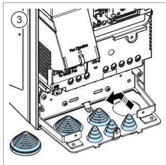
注：传动发货时，护套锥指向上方。拆下并插回护套锥时，必须使其指向下方。
