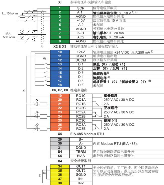
辅助电压输出 +24 V (X2:10) 的总负载能力为 6.0 W (250 mA / 24 V 直流)。
