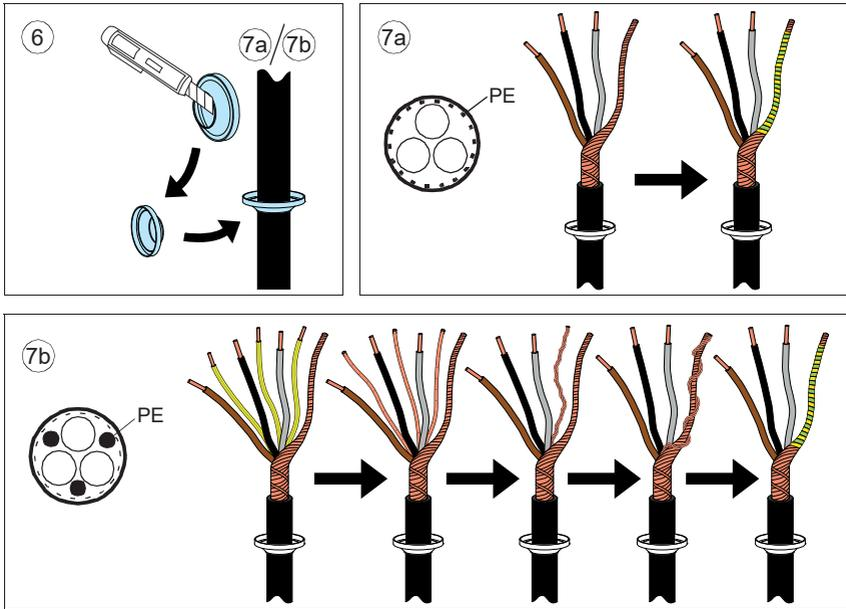
8. 将电缆穿过电缆入口处的孔，并把橡胶护套到孔上（电机电缆在右，动力电缆在左）。
