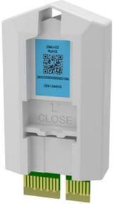
存储器单元定义了伺服驱动器的标识和功能，并储存伺服驱动器的固件和所保存的参数。存储器单元存储Mint程序，具有编程能力。存储器单元为伺服驱动器的基本部件，必须始终配备。不宜频繁拔出和插入。
