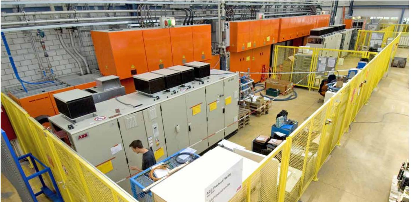
Chaque variateur livré par ABB subit tous les essais servant à démontrer sa fiabilité, la qualité de ses composants et le respect du cahier des charges du client. Ces essais sont réalisés au moyen d'équipements ultra-modernes.
