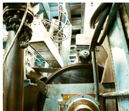
不锈钢处理线中的Millmate带材边部位检测系统
