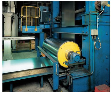
平整机中的Millmate带材边部位置检测系统和Stressometer平直度控制系统
