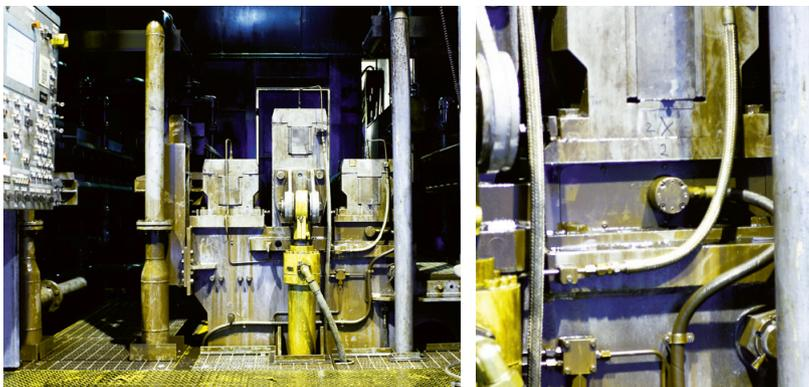
冷连轧机中的大型枕式张力仪
