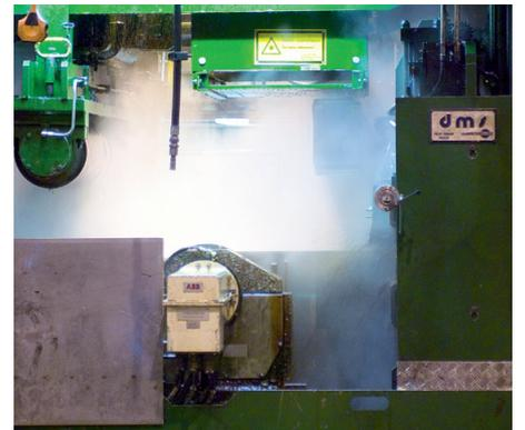
平整机中的Stressometer平直度控制系统和Millmate带钢张力仪
