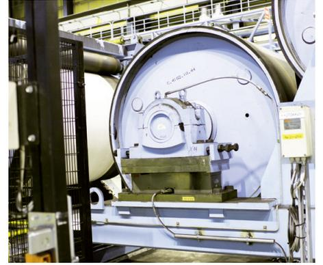
退火酸洗线张力辊中的大型枕式张力仪
