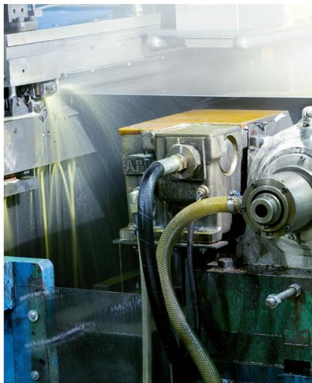
可逆冷轧机中的Stressometer平直度控制系统和Millmate带材边部位置检测系统
