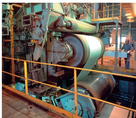
冷连轧机进口张力辊中的Millmate带钢张力仪
