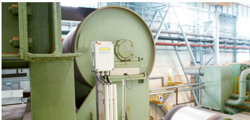
带钢生产线中的大型枕式张力仪
