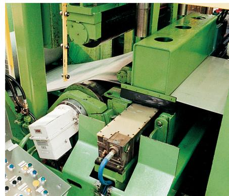
不锈钢多辊冷轧机中的Stressometer平直度控制系统和Millmate带材边部位检测系统
