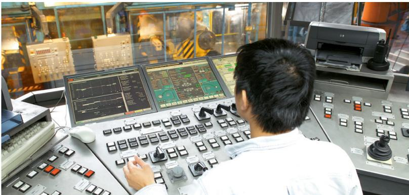
可逆冷轧机中的Stressometer平直度控制系统
