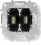
Toma cargador USB 2x 2A/5V      | 8185.3 | Tensión: 110-230V AC ± 10%<br>Frecuencia entrada: 50 - 60Hz<br>Corriente de entrada: 0,20 A AC<br>Tensión de salida: 5V DC +5 /-5%<br>Corriente de salida: 2000 mA por cada toma.<br>Compatible con conectores USB A.<br>Tapa ref. 8585.3 |
