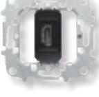
Toma HDMI hembra-hembra | 8155.7 | Frontal: Conector 1x HDMI (Tipo A)<br>Trasera: Conector 1x HDMI (Tipo A) a 90°<br>Sin garras.<br>Tapa ref. 8555<br>Ver esquemas y dimensiones para determinar compatibilidad con cajas y modo de instalación.       |
