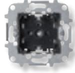
Bipolar con TT lateral Schuko conexión automática | 8188.6 | 16 A ; 250 V~<br>Proteccion contra contactos directos involuntarios.<br>Conexion tipo "borne sin tornillos". Reduce los tiempos de instalacion en un 40%.<br>Tapa ref. 8588 |
