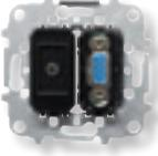
Toma VGA + Mini-jack | 8155.54 | Frontal: Conector 1 x VGA (DE 15 pines) y Conector 1x Mini-jack (r3,5mm stereo audio jack)<br>Trasera: 1x VGA conexión por tornillo (15 hilos) y 1x Mini-jack conexión por tornillo (3/4 hilos)<br>Sin garras. Tapa ref. 8555.4 |
