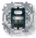
Salida de cable | 8107   | Con brida de fijación<br>Tres bornes de conexión hasta 2,5 mm <sup>2</sup><br>Tapa ref. 8607 |
