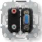
Toma VGA + 2RCA      | 8155.52 | Frontal: Conector 1 x VGA (DE 15 pines) y Conector 2x RCA (rojo/blanco)<br>Trasera: VGA conexión por tornillo (15 hilos) y RCA conexión por tornillo (4 hilos)<br>Sin garras. Tapa ref. 8555.6                                  |
