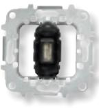
Toma cargador USB 1x 2A/5V      | 8185.2 | Tensión: 110-230V AC ± 10%<br>Frecuencia entrada: 50 - 60 Hz<br>Corriente de entrada: 0,20 A AC<br>Tensión de salida: 5V DC +5 /-5%<br>Corriente de salida: 2000 mA<br>Compatible con conectores USB A.<br>Tapa ref. 8585.2               |
