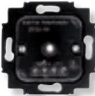
Regulador electrónico giratorio 1-10 VDC                             | 8160.9  | 230 V~ ; 50 Hz.<br>Válido para luminarias con balasto electrónico regulable 1-10VDC.<br>Potencia: 700 W / VA<br>Tensión de control: 1 - 10 V DC<br>Corriente max. de control del balasto: 50 mA DC.<br>Tapa ref. 8560.2                                                                                                                                                                    |
