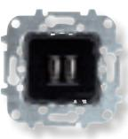
Toma cargador USB doble 1,5A/5V | 8185   | Tensión entrada: 100 - 240 V AC ± 10%<br>Frecuencia entrada: 50 - 60 Hz<br>Corriente entrada: 0,20 A AC<br>Tensión salida: 5V DC +5 /-5%<br>Corriente salida: 1500mA compartidos.<br>Compatible con conectores USB A.<br>Tapa ref. 8585   |
