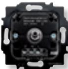
Mecanismo giratorio universal                                        | 8161.8  | 230 V~ ; 50 Hz<br>Elemento auxiliar que se conecta con el mecanismo 8160.8 para poder regular la carga desde varios puntos.<br>Se pueden conectar hasta 5 elementos auxiliares.<br>Tapa ref. 8560.2                                                                                                                                                                                        |
