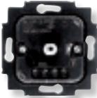
Regulador electrónico giratorio halógenas y transf. electromagnético   | 8160    | 230 V~ ; 50 Hz.<br>☼ ⚡ 20 - 500 W<br>Motores hasta 300 VA<br>Apto para regulación de lámparas de LED regulables.<br>Tapa ref. 8560.2                                                                                                                                                                                                                                                       |
