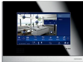
**Confort Panel Negro.** Es la máxima expresión de control de toda la instalación para el usuario, que podrá disponer además de una cámara IP incorporada y de una conexión a Internet
