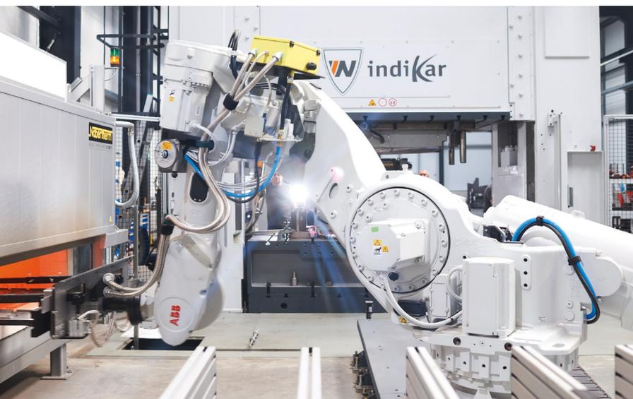
— Mit dem Roboter erhöht IndiKar die Präzision beim Handling der Stahlplatten.
