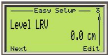
O LRV (Lower Range Value) de nível é a configuração para o valor menor, medido em unidades de engenharia, em que os transmissores de LMT criarão saída. O LRV também é referido como ponto zero. O LRV está definido para zero de fábrica. Note que dependendo das definições do dispositivo, o LRV de nível também pode ser exibido como LRV de nível de volume ou LRV de fluxo
