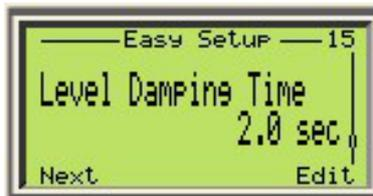
O amortecimento é uma configuração designada para atrasar a resposta do resultado para uma modificação no nível medido. Se o processo for agitado ou se existir a possibilidade de derrame do líquido, um valor mais alto de amortecimento pode ser necessário. Se o processo mudar de maneira muito rápida, um valor de amortecimento mais baixo pode ser necessário para melhorar o tempo de resposta para uma mudança de nível. O valor do amortecimento mais alto permitido é de 60 segundos.
