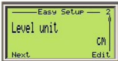
A opção Unidade de nível permite que o usuário selecione a unidade da medição para a medição de nível. Esta unidade de medição fornece, então, uma base para todas as funções de configuração. Unidades de engenharia selecionáveis incluem: polegadas, pés, metros, centímetros e milímetros. Note que dependendo das definições do dispositivo, a Unidade de nível pode ser exibida como Unidade de volume ou Unidade de fluxo.
