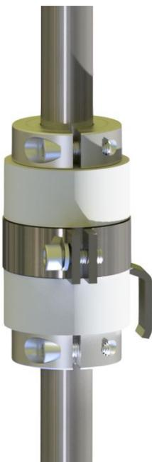
Para comprimentos de medida (ML) de 914,4 mm (36 pol.) ou menores, um mínimo de dois conjuntos VI-KIT é recomendado para a instalação em aplicações de alta vibração.
