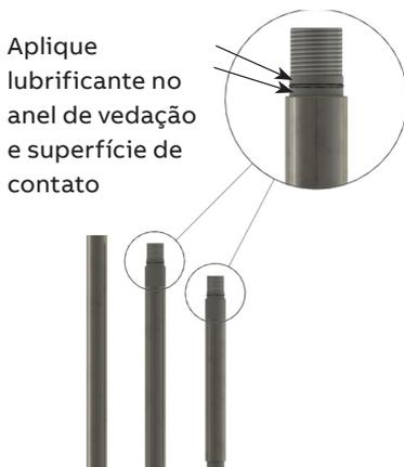
Figura 8 Conexão roscada do poço W7
