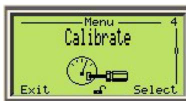
O menu Calibrar permite a calibração local do instrumento. Isto inclui a definição de pontos de calibração e o valor de desvio para o nível, interface do líquido (para dois líquidos) e temperatura.
