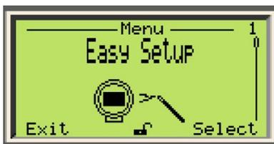
Esse menu permite a verificação e definição de parâmetros para a configuração básica dos transmissores de nível da Série LMT. A Configuração fácil guia o usuário à escolha do idioma da interface, configuração do número de etiqueta, unidades de engenharia, valor de alcance máximo e mínimo (URV e LRV) e modo de exibição do visor (o valor que precisa ser visualizado no HMI).
