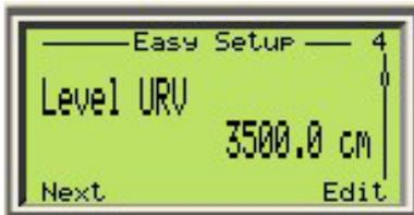
O URV (Upper Range Value) de nível é a configuração para o valor maior, medido em unidades de engenharia, em que os transmissores de LMT criarão saída. Esse ponto é geralmente chamado de ponto de abrangência. Note que dependendo das definições do dispositivo, o URV de nível também pode ser exibido como URV de nível de volume ou URV de fluxo
