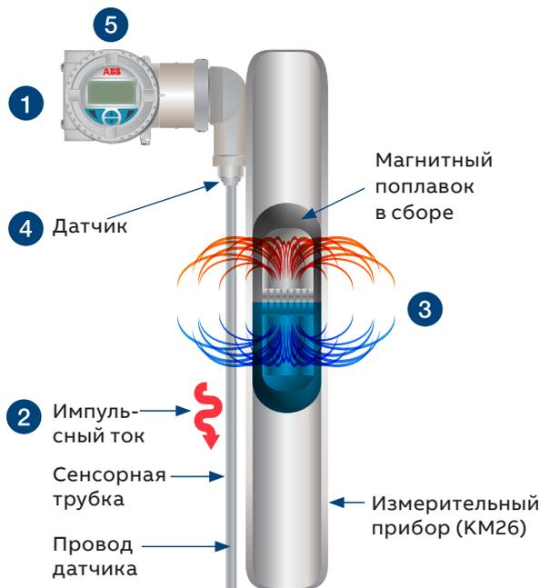
Рис. 2 LMT200 (монтаж на измерительном приборе (KM26))
