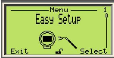
С помощью этого меню пользователь может проверять и настраивать базовые параметры приборов LMT. Меню Easy Setup (Простая настройка) позволяет пользователю выбирать язык интерфейса, настраивать идентификационный номер прибора, технические единицы, верхнее и нижнее значение диапазона (URV и LRV), а также режим отображения данных на дисплее (значения, которые будут видны на дисплее ЧМИ).
