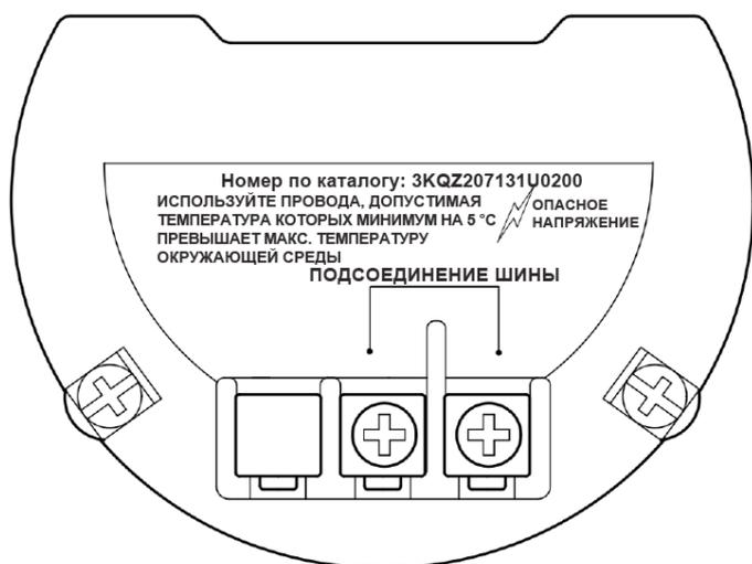
Рис. 20 Клеммная колодка FF с защитой от скачков напряжения.
