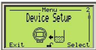
Это меню позволяет просматривать и устанавливать параметры для устройств серии LMT. Это меню позволяет устанавливать защиту от записи, задавать пароли для контроля доступа, настраивать основные переменные (ед. изм., LRV и URV), выбирать функции передачи (тип линейаризации и отсечение низкого расхода), масштабировать выходной сигнал (ед. изм. в зависимости от измерения и LRV / URV). Последнее из подменю позволяет пользователям сбросить все параметры к значению по умолчанию.
