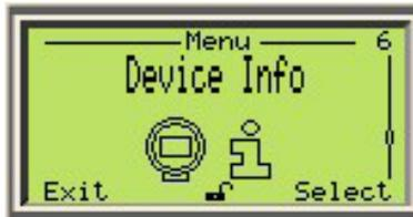
В этом меню пользователь может просматривать всю информацию об устройстве. Структура меню дает возможность просматривать тип сенсора, версии аппаратного и программного обеспечения, нижний и верхний пределы сенсора, а также минимальный разбег.
