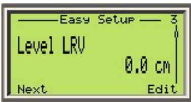
Level LRV (Нижнее значение диапазона уровня) — настройка нижнего значения в технических единицах, при котором датчик LMT будет подавать сигнал. Нижнее значение диапазона также называют нулевой точкой. Нижнее значение диапазона настроено на ноль на предприятии-изготовителе. В зависимости от настройки устройства меню Level LRV может отображаться также как Volume Level LRV или Flow LRV.
