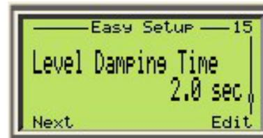
Демпфирование позволяет замедлить изменение выходного сигнала при изменении уровня. Если технологическая среда перемешивается, либо на ее поверхности присутствует волнение, то может потребоваться более высокое значение демпфирования. При быстром изменении уровня технологической среды может потребоваться более низкое значение демпфирования, что позволит лучше отслеживать изменение уровня. Максимально возможное значение демпфирования составляет 60 секунд.
