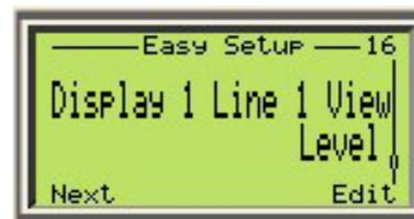
Строка дисплея может быть настроена на отображение значений Raw Level (Исходный уровень), Distance/Ullage (расстояние/незаполненный объем) и Level (Уровень). Если прибор используется для измерения двух значений уровня, также можно настроить отображение значения Interface (Уровень раздела фаз). На гистограмму можно выводить процентное значение диапазона или процентное значение тока (mA).
