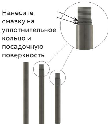
Рис. 8 Резьбовой разъем для установки кармана W7
