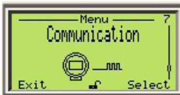
В последнем меню пользователь может менять идентификационный номер прибора, используемый для связи с ним, активировать режим MULTI-DROP (МНОГОТОЧЕЧНЫЙ РЕЖИМ), а также менять FF-адрес устройства. Кроме того, здесь присваиваются значения переменных для FF-адресов (PV, SV, TV, QV).
