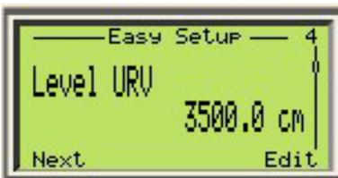
Level URV (Верхнее значение диапазона уровня) — настройка верхнего значения в технических единицах, при котором датчик LMT будет подавать сигнал. Также это значение называют точкой диапазона. В зависимости от настройки устройства меню Level URV может отображаться также как Volume Level URV или Flow URV.
