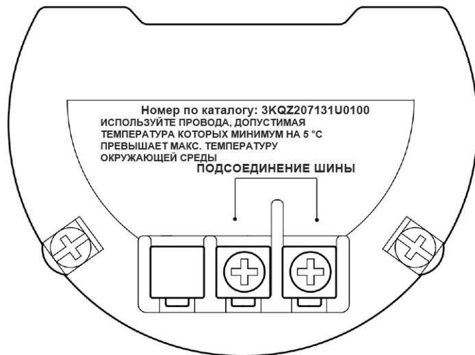
Рис. 18 Клеммная колодка FF без защиты от скачков напряжения.
