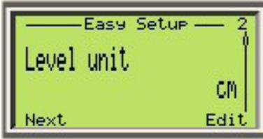
В данном разделе меню можно выбрать единицы измерения уровня. Выбранные единицы измерения затем применяются ко всем функциям настройки. Доступные технические единицы: дюймы, футы, метры, сантиметры и миллиметры. В зависимости от настроек устройства меню Level Unit (Единицы измерения уровня) может отображаться также как Volume Unit (Единицы объема) или Flow Unit (Единицы расхода).
