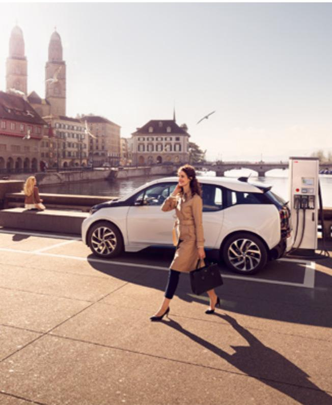
Die Terra 54 ist die weiterentwickelte Generation der in Europa meistverkauften 50 kW Gleichstrom-Ladestation Terra 53. Zur Unterstützung der zunehmend leistungsfähigeren EV-Batterien ermöglicht Terra 54 das kontinuierliche Laden mit 50 kW bei 200 – 500 V, während die Terra 54HV sogar 200 – 920 V unterstützt.
